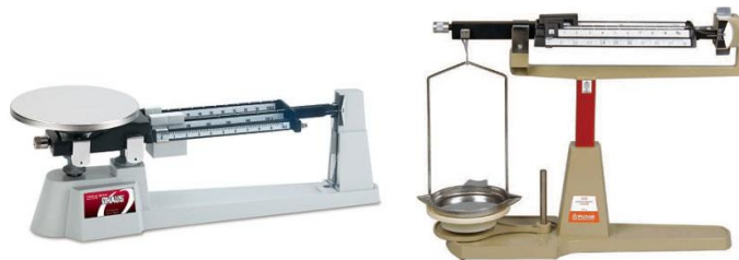
Gambar 2. 23 Neraca teknis tiga lengan
