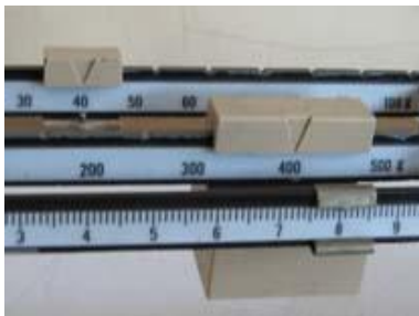
Gambar 2. 25 Skala hasil ukur neraca 1
