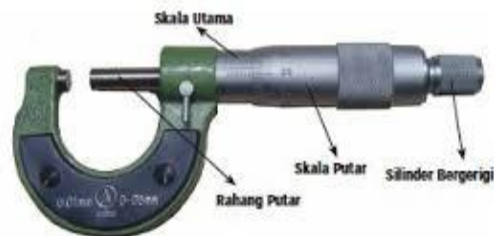
Gambar 2. 20 Bagian-bagian micrometer sekrup
