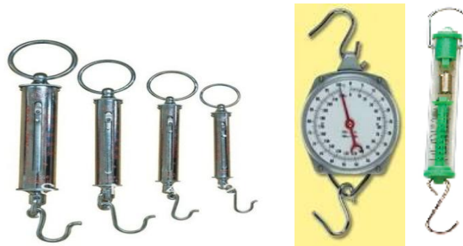
Gambar 2.9 Berbagai jenis Dinamometer
